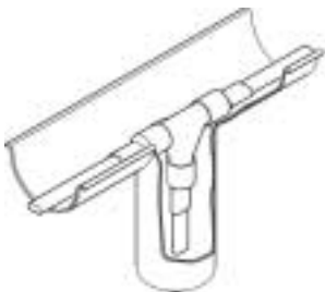
Formvergossene T-Abzweigmuffe zur Fallrohrbeheizung
