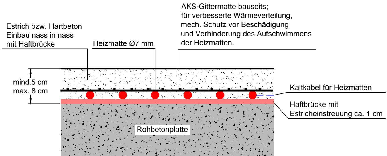
Der Estrichverbund mit der Rohbetonplatte ist zu gewährleisten.
